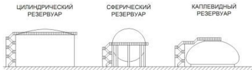
Рисунок 2 – Виды резервуара по форме корпуса.
