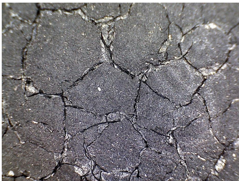
Рисунок 3.12 – Микрофотография поверхности полидидициклопентадиена, обработанного концентрированной серной кислотой в течение 60 сут
