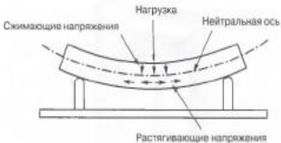
Рисунок 2.7 - Напряжения, возникающие под действием изгибающей нагрузки
