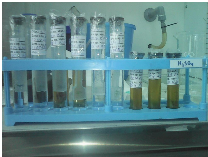
Рисунок 2.11 - Выдерживание образцов из ПДЦПД в агрессивных средах
