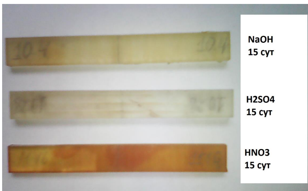
Рисунок 3.1 – Изменение окраски образцов, после выдержки в агрессивных средах 15 суток
