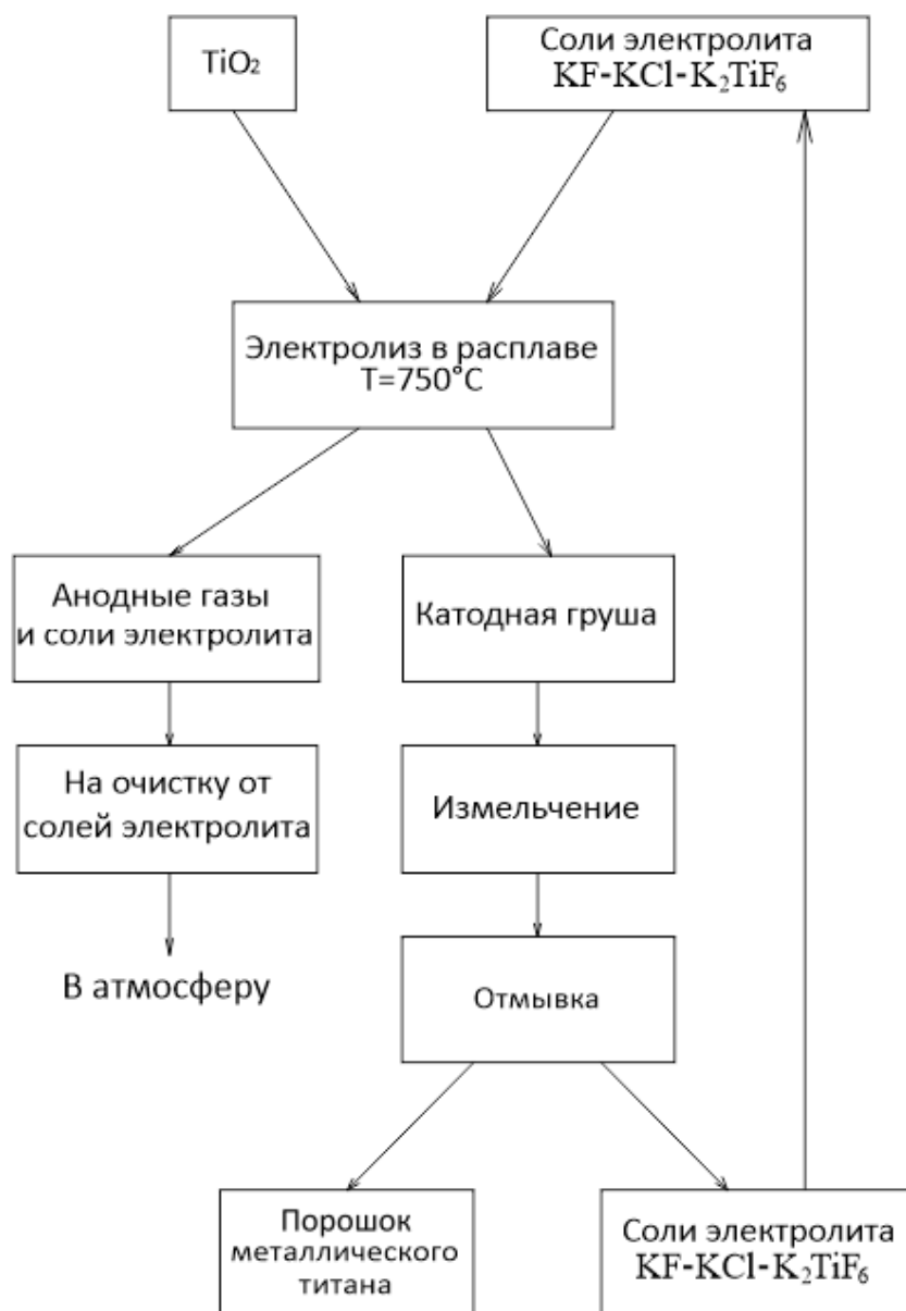
Рисунок 12 – Принципиальная блок-схема фторидно-хлоридной технологии
