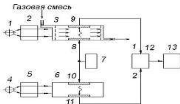
Рис. 21 – Фототермоакустический газоанализатор: 1, 4 - источники широкополосного инфракрасного излучения, 2, 5 - фильтрационные кюветы, 3 - измерительная кювета [49], 6 - сравнительная кювета, 7 - генератор электрических импульсов, 8, 9, 10, 11 - излучатели и приемники ультразвуковых колебаний
