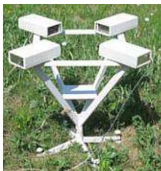
Рис. 5 – Двухканальный оптический измеритель осадков ОДИО: 1 - диодный лазер ( \lambda = 0.69 мкм), 2 - коллиматор, 3 - защитное стекло, 4 - многоканальный фотоприемник, 5, 6 - микропроцессор [65], 7 - выходной интерфейс
