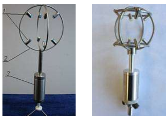
Рис. 2 – Конструкция 3D-УТА ДСВ-15 (а) и УТАМ-75 (б): 1 – ЭАП (излучатели и приемники) 2 – поддерживающая арматура; 3 – корпус с электронными платами.
