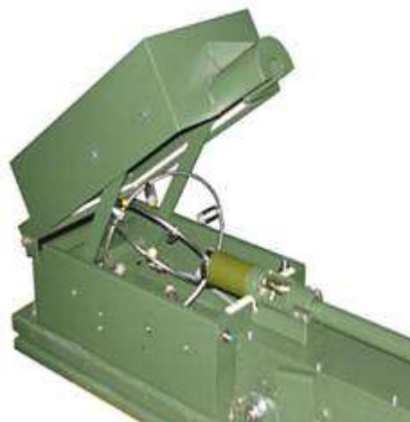
Рис.10 – АСКФ АМК-03Б (1Б65Б): 1, 2 – излучатели и приемники 1-го и 2-го каналов, 3 - измеритель временных интервалов, 4, 6 – основное и дополнительное вычислительные устройства, 5 - устройство сравнения, 7 - бокс-контейнер, 8 - датчик закрытия бокса-контейнера, 9 - дополнительный датчик температуры воздуха
