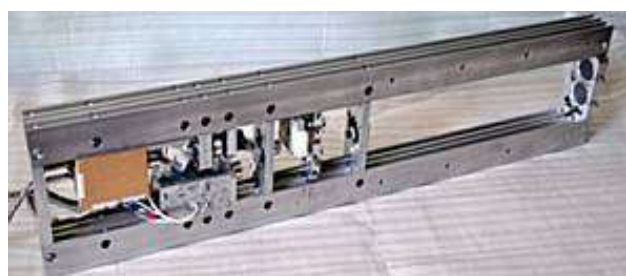
Рис. 19 – Внешний вид конструкции и блок-схема анализатора паров ртути РГА/м: 1 - ртутная лампа, 2 - линза, 3 - поляризационный компенсатор, 4 - полуволновая фазовая пластинка, 5 - призма Глана, 6 - плоские зеркала, 7 - интерференционный фильтр, 8 - линза, 9 - фотодетектор, 10 - эталонная кювета, 11 - линза, 12 - входное и выходное окна измерительной кюветы, 13, 14, 15 - сферические зеркала измерительной кюветы, 16 - линза
