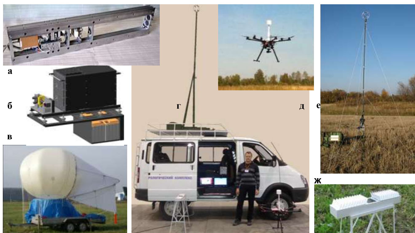
Рис. 28 – Мобильный измерительный комплекс МИК в составе: а) ртутный газоанализатор, б) многокомпонентный СКР-газоанализатор, в) привязной аэростат К-25М/А с метеостанцией ПУМС, г) автомобиль ГАЗ («Соболь») с бортовой УАМС АМК-03Б, д) гексакоптер DJI S900 с метеостанцией ПЭМС, е) переносная УАМС АМК-03П, ж) измеритель осадков ОПТИОС-01.
