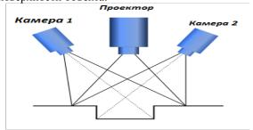
Рисунок 1 – принципиальная схема сканирования.
