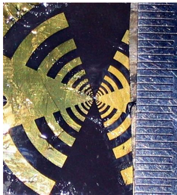
Рисунок 1.3 – Топология антенн детекторов: а) – ДП21М; б) – ДПММ-01
