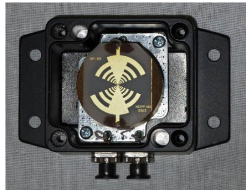
Рисунок 1.3 – Топология антенн детекторов: а) – ДП21М; б) – ДПММ-01
