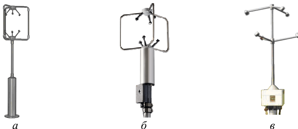
Рисунок 1.5 - Ультразвуковые термоанемометры: а – R3-50 (R.M. Young Company); б – Model 81000 (Metek); в – USA-1 (Biral)
