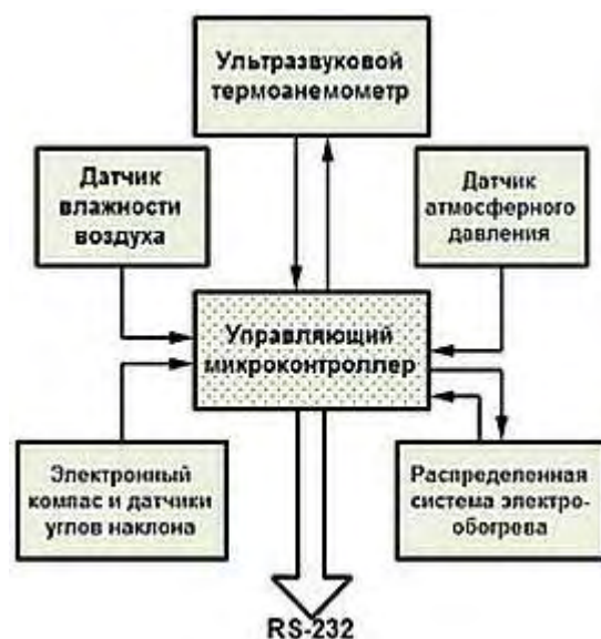
Рисунок 2.44 - УАМС АМК-03: внешний вид и структурная схема
