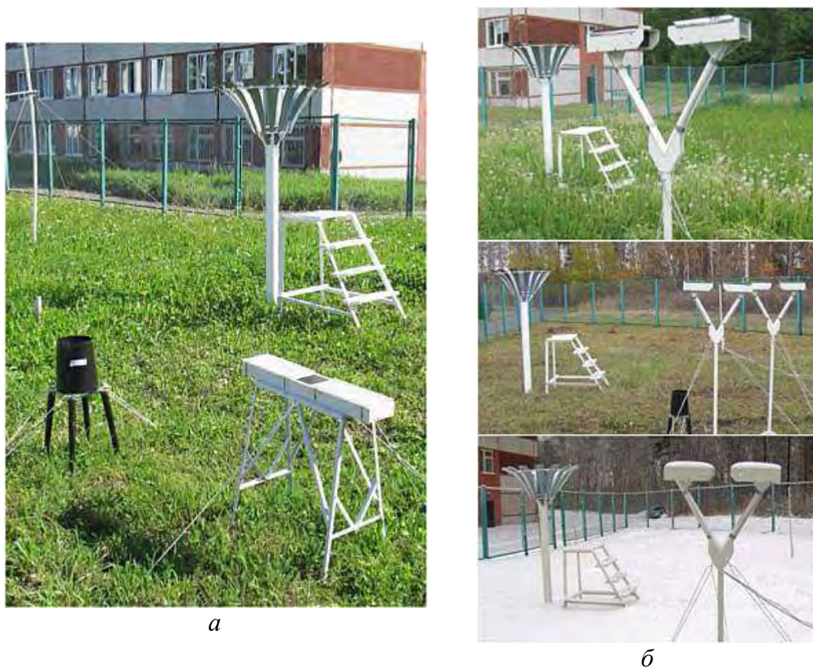
Рисунок 2.36 - Натурные испытания ОПТИОС с референтными приборами (осадкомер М-99 и DavisRainCollector ) на метеорологической площадке ИМКЭС СО РАН: а – ОПТИОС-01 (лето); б – ОПТИОС-02 (лето и зима)
