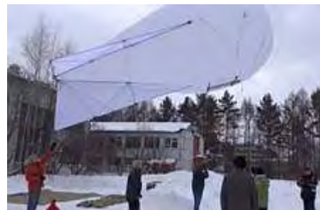
Рисунок 3.12 - Натурные испытания ПУМС на платформе гибридного аэростата К-25М/А
