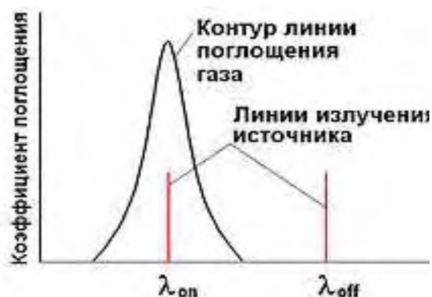
Рисунок 4.2 – Метод дифференциальной спектроскопии: спектр излучения источника и спектр поглощения газа)
