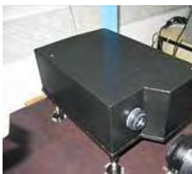
Рисунок 4.38 - Конструкция блоков СКР-газоанализатора: а – спектрометр СКР-газоанализатора (расположение оптических элементов и внешний вид), б – многопроходная оптическая система и объектив для сбора рассеянного света
