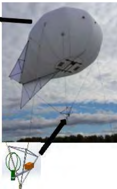
Рисунок 3.12 - Натурные испытания ПУМС на платформе гибридного аэростата К-25М/А
