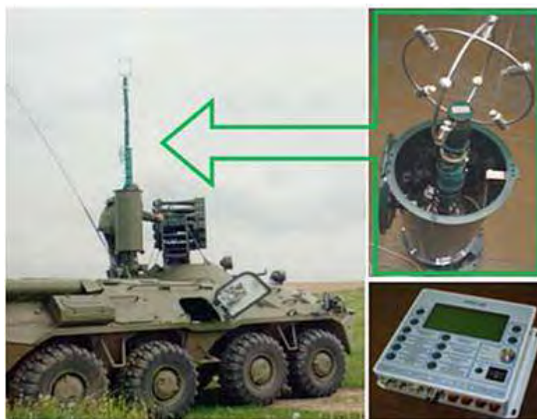
Рисунок 2.61 - БМК-01 в составе бортовой системы оперативного прогнозирования дальности и качества звукового вещания. Справа вверху – метеокомплекс с телескопической метеомачтой; справа внизу – пульт управления метеокомплексом
