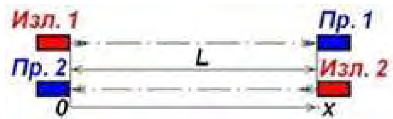
Рисунок 2.1 - Принцип метода ультразвуковой термоанемометрии
