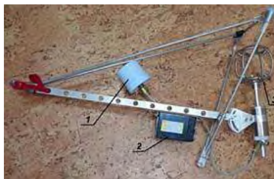
в) 1 – приемопередатчик ПДД-11-1, 2 – аккумулятор, 3 – АМК-03А
