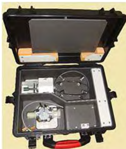
Рисунок 2.70 - Внешний вид экспериментального образца ПККУТ в переносном кейсе с установленным в нем ультразвуковым термоанемометром (блок УГИ 1Б65)
