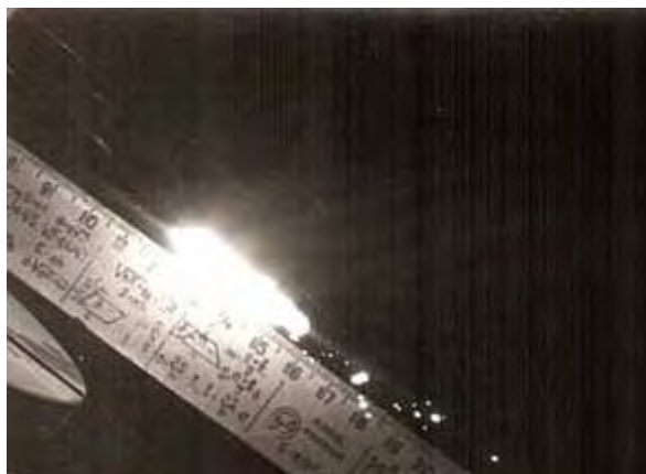
Рисунок 3.26 - Оптический пробой воздуха неодимовым лазером с пассивным модулятором добротности (дистанция – 20 м)
