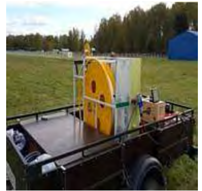
Лебедка с тросом и электромеханическим приводом (в прицепе)
