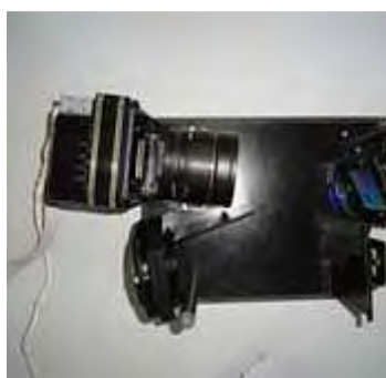
Рисунок 4.38 - Конструкция блоков СКР-газоанализатора: а – спектрометр СКР-газоанализатора (расположение оптических элементов и внешний вид), б – многопроходная оптическая система и объектив для сбора рассеянного света
