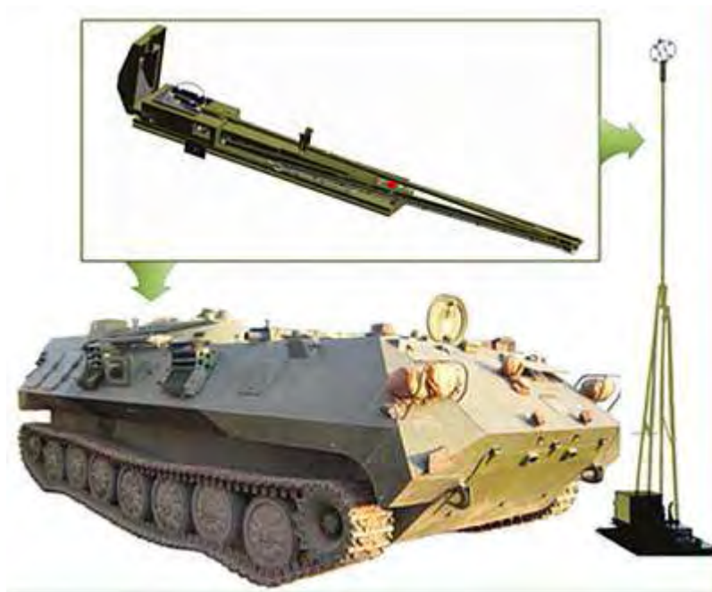
Рисунок 2.63 - Бортовой метеорологический комплекс (изделие 1Б65Б) в составе машины управления 1В1002 комплекса 1В197 (справа - развернутое состояние комплекса)
