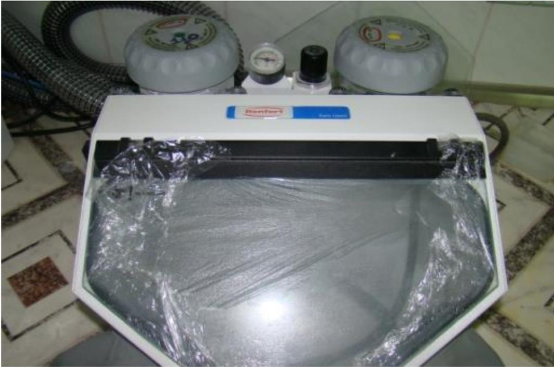
**Рисунок 1 – Пескоструйный аппарат «Basic classic», фирма «Renfert» (Германия)**
