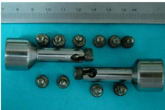
**Рисунок 4.13** - Образцы из сплава «Титанид» в виде «гирек» и выточенные держатели из стали
