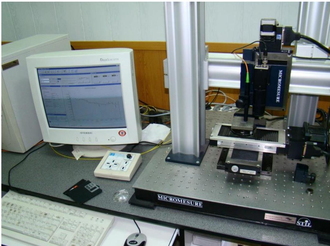
**Рисунок 2- Бесконтактный профилометр «MICROMEASURE 3D station» (Франция)**
