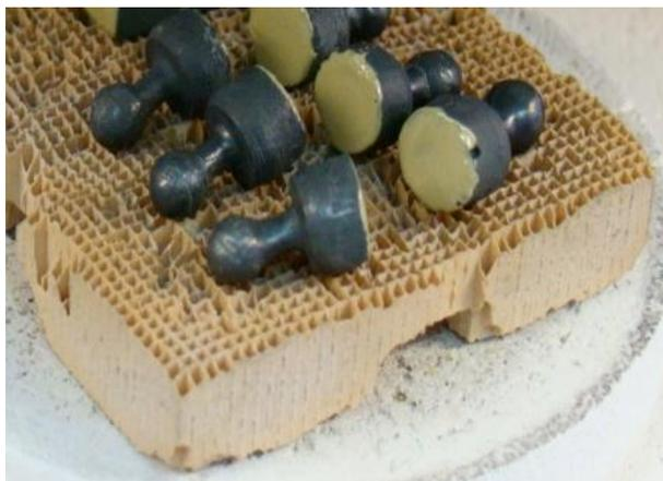
**Рисунок 4.14** – Предгрунтовый слой, нанесенный на торцевую поверхность «гирьки» из сплава «Титанид»
