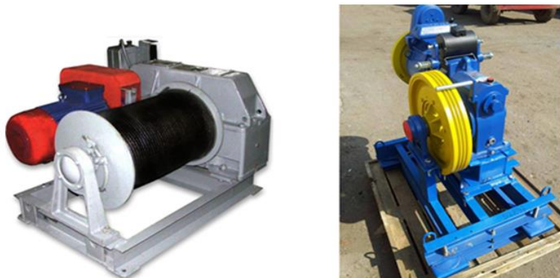
Рисунок 1.1 – Лебедки: барабанного типа (слева), с канатоведущим шкивом (справа)
