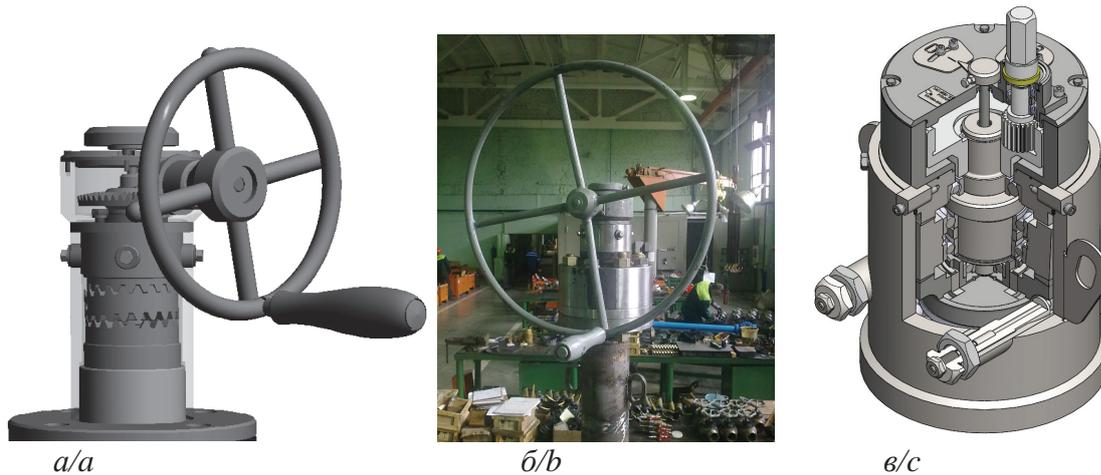
**Рис. 2.** Приводы к шаровым кранам: а) шаровый кран и привод над землей, б) шаровый кран на глубине, привод надземный; в) шаровый кран и привод на глубине (входной вал расположен вертикально)
