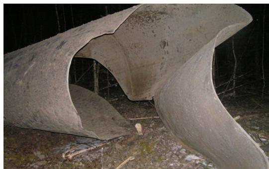
**Рис. 2.** Аварийные разрушения на магистральном газопроводе «Ямбург-Елец 1» по причине стресс-коррозии
