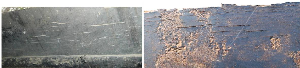
Рис. 1. Стресс-коррозионные трещины на внешней поверхности трубопровода
