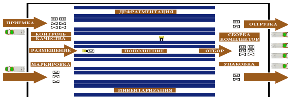
Рисунок 1 – Принцип функционирования программы ARENA.WMS
