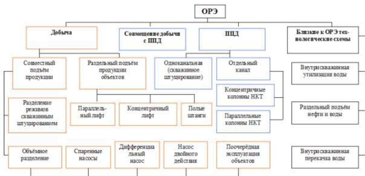
Рисунок 2 – Классификация технологических схем и установок для ОРЭ для разработки нефтяных месторождений
