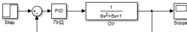
Рисунок 3.1 – Схема моделирования САУ с ОУ второго порядка
