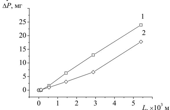
Рис. 6. Зависимости потери массы образцов от пути скольжения сплава ПТ-3В в КЗ состоянии при испытании на износ: 1) обычные испытания; 2) с гашением акустических колебаний на образцах и контртеле
