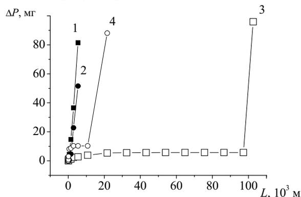
**Рис. 5.** Зависимости потери массы образцов сплава ВТ6 от пути скольжения при испытании на износ: 1) образцы в исходном состоянии; 2) в УМЗ состоянии; 3, 4) в исходном и УМЗ состояниях с гашением акустических колебаний на образцах и контртеле
