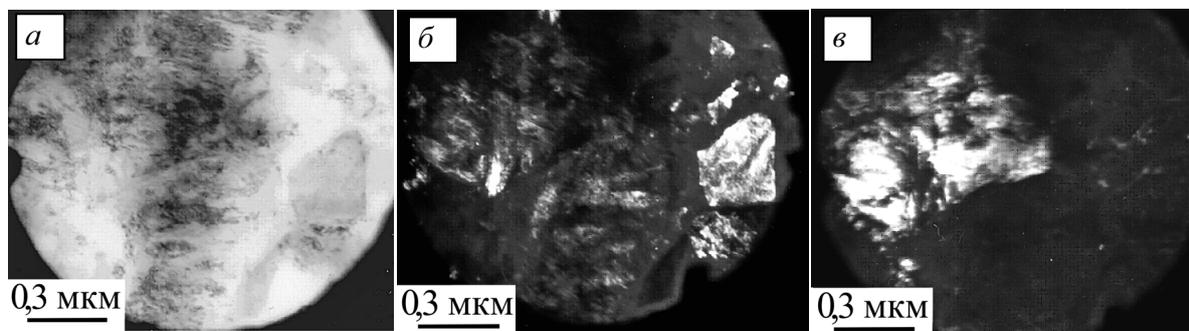
Рис. 1. Электронномикроскопические изображения микроструктуры сплава ВТ6 после всесторонней изотермической деформации с конечной температурой деформации 600 °С: а) светлопольное; б) темнопольное в рефлексе  $\beta$ -Ti; в) в рефлексе  $\alpha$ -Ti
