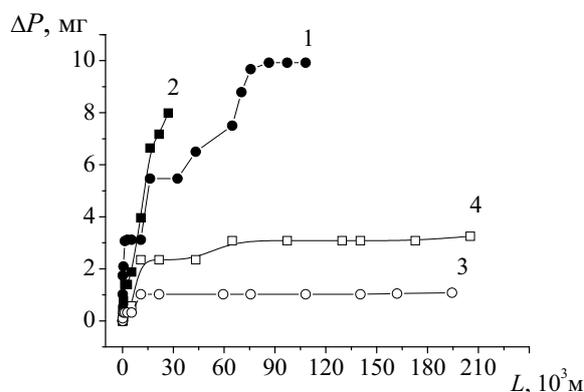
**Рис. 4.** Зависимости потери массы образцов от пути скольжения при испытаниях на износ: 1, 3) образцы титана ВТ1–0 в исходном состоянии; 2, 4) ВТ1–0 в УМЗ состоянии. Кривые 1, 2) обычные испытания; 3, 4) испытания с гашением акустических колебаний на образцах и контртеле
