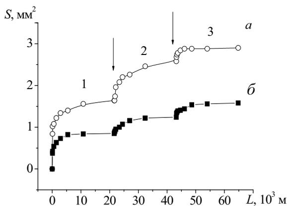
**Рис. 3.** Зависимости изменения площади пятен контактов от пути скольжения образцов армко-железа при испытаниях на трение: а – испытания с различным расположением демпферов: 1) участок с использованием демпферов на контртеле и образцах; 2) демпферы только на образцах; 3) без демпферов; б – испытания на трение со ступенчатым повышением нагрузки: 1) участок испытаний при нагрузке 200; 2) 300; 3) 400 Н
