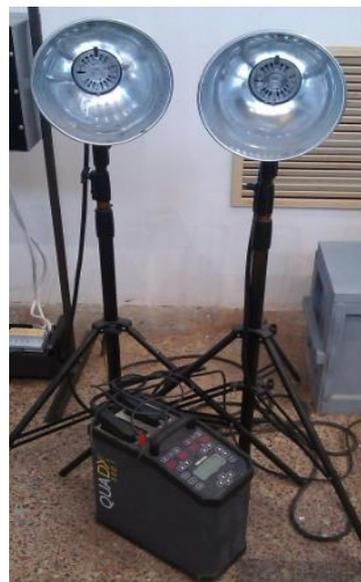
б – Импульсные ксеноновые лампы вспышки мощностью 3,2 кДж
