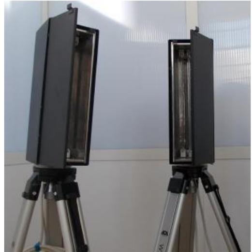
г – Специализированный источник нагрева на галогеновых лампах общей мощность  $2 \times 6$  кВт
