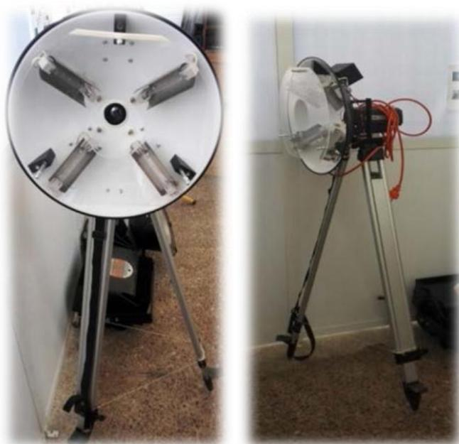
Рисунок 2.5 – Портативный тепловой дефектоскоп, прототип универсального прибора (в качестве источников нагрева использованы галогеновые лампы суммарной мощностью 2 кВт)
