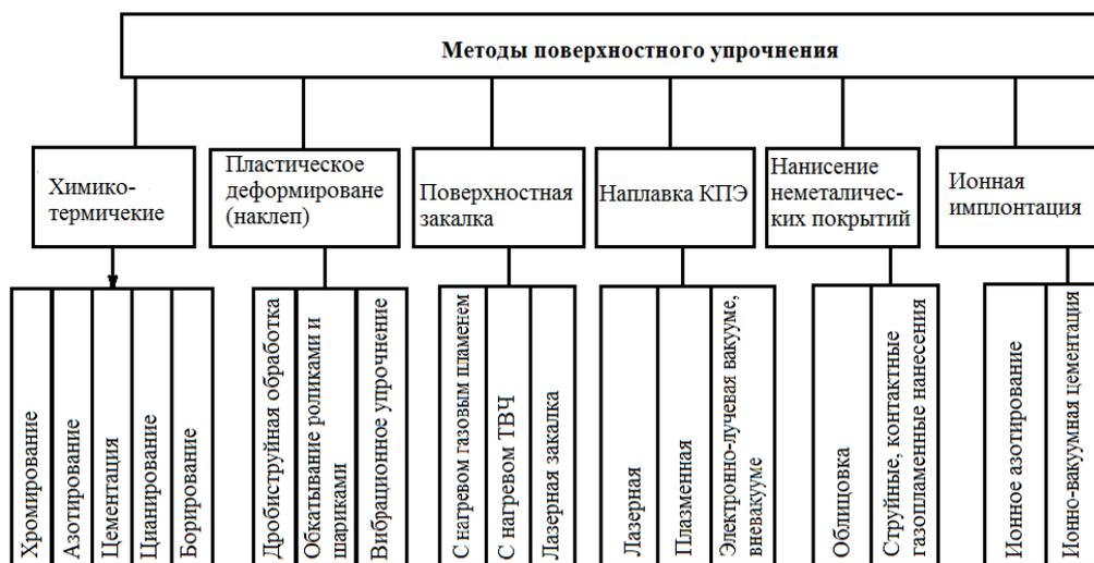
Рисунок 1.4 – Методы поверхностного упрочнения
