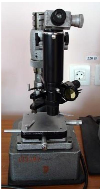
Рисунок 4.1 – Микротвердомер ПМТ-3М
