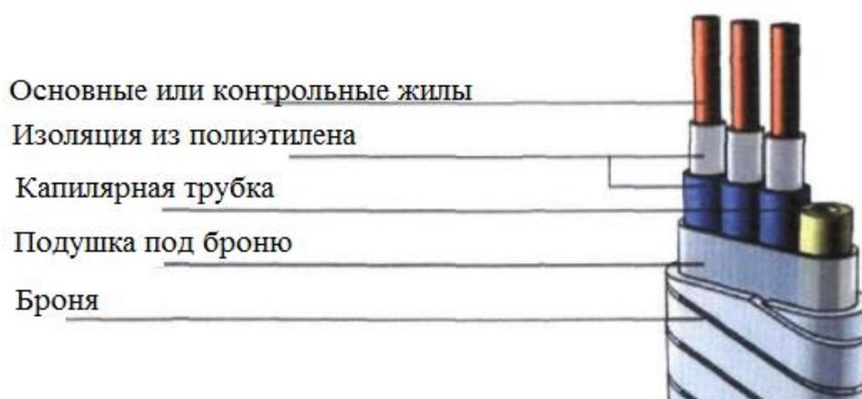
Рисунок 7 - Конструкция специального погружного кабельного устройства (СПКУ)
