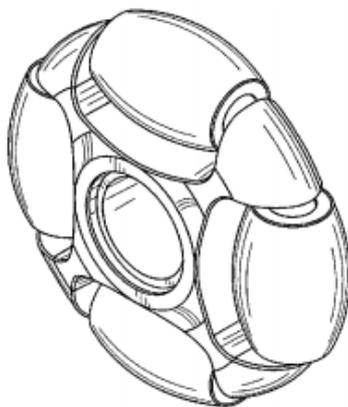
Рисунок 18 – Всенаправленное колесо с роликами, ось вращения которых расположена под углом 90 градусов к оси вращения всего колеса
