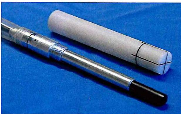
Рисунок 2 – Ионизационная камера FC65-G [2]
