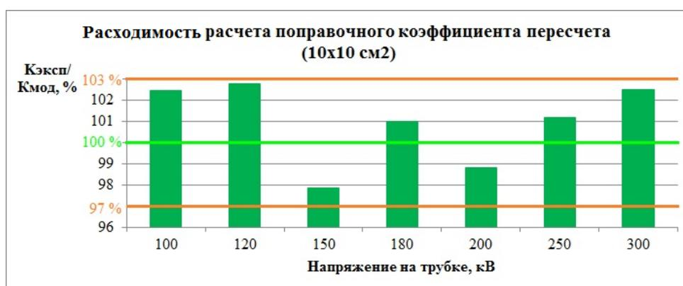
Рисунок 14 – Расходимость расчета поправочного коэффициента пересчета для всех напряжений на трубке для размера поля 10x10 см<sup>2</sup>
