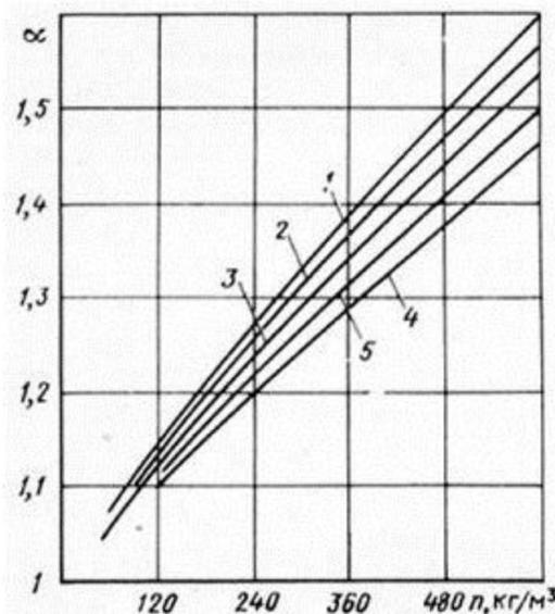
Рисунок 2.1 - График зависимости поправочного коэффициента от концентрации песка для разной плотности: 1 -  $Q_{ж} = 800$  кг/м<sup>3</sup>; 2 - 850 кг/м<sup>3</sup>; 3 - 900 кг/м<sup>3</sup>; 4 - 950 кг/м<sup>3</sup>; 5 - 1000 кг/м<sup>3</sup>;
