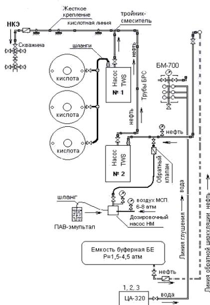
Рисунок 3.3 - Схема размещения оборудования на верхней палубе МСП при обработке скважин нефтекислотной эмульсией.
