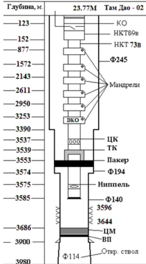
Рисунок 4.1 - схема структуры эксплуатационной скважины № 7006.
