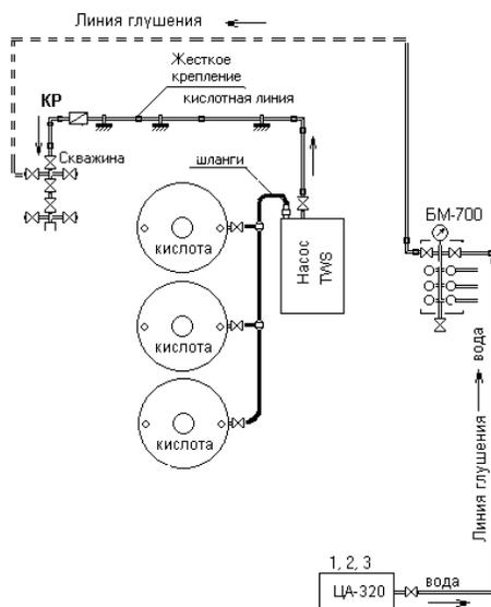
Рисунок 3.1 - Схема размещения оборудования на верхней палубе МСП при кислотной обработке скважин.
