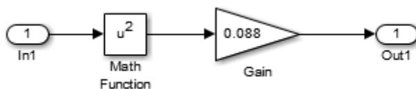
Рисунок 14 – Подсистема «Funktion» при законе регулирования  $U_1/f_1^2 = \text{const}$
