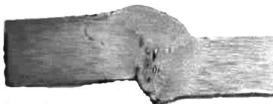
Рисунок 5.2 Разрез реального сварного шва с микро- и макродефектами.
