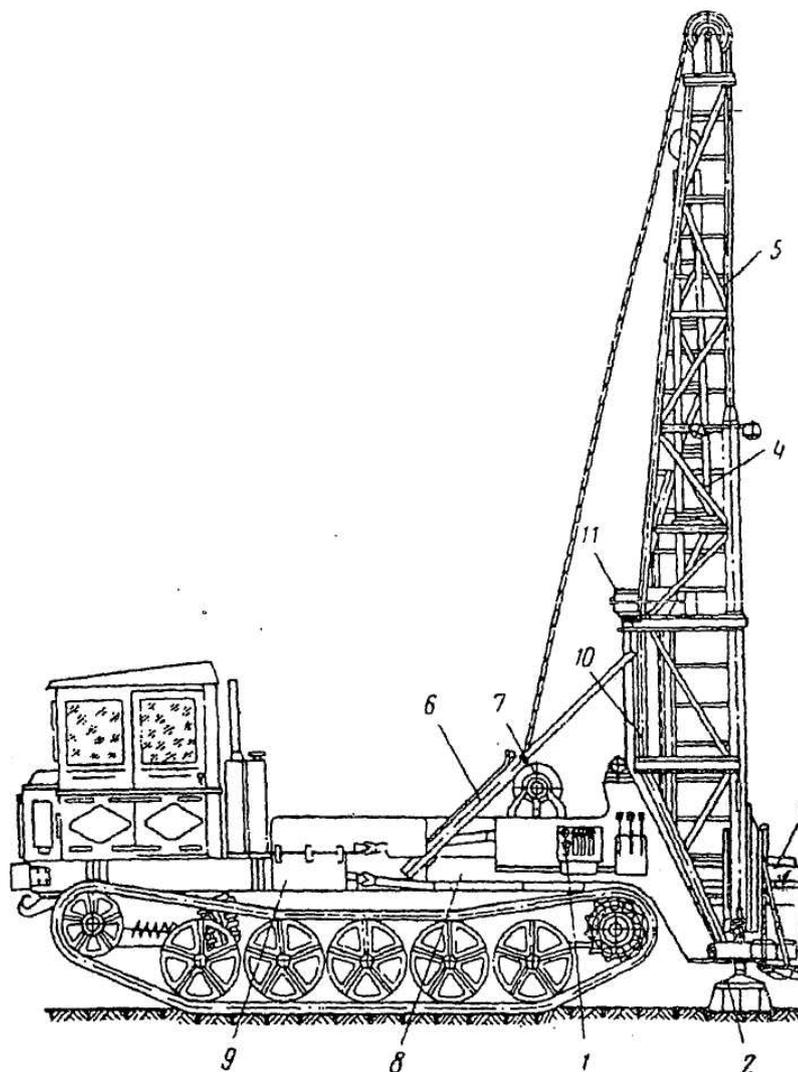
Рисунок 5.1 – Буровая установка УРСБ-25: 1 – пульт управления; 2 – домкраты; 3 – ротор; 4 – укосина; 5 – мачта; 6 – гидроцилиндры; 7 – лебедка; 8 – конический редуктор; 9 – коробка передач; 10 – вертикальный вал; 11 – верхний редуктор
