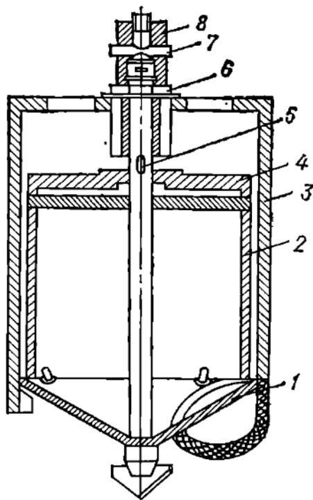
Рисунок 5.5 – Ковшовый бур на штангах установки УБСР-25: 1 – днище; 2 – кассета; 3 – корпус; 4 – крышка; 5, 6, 8 – пальцы; 7 – трехгранный хвостовик
