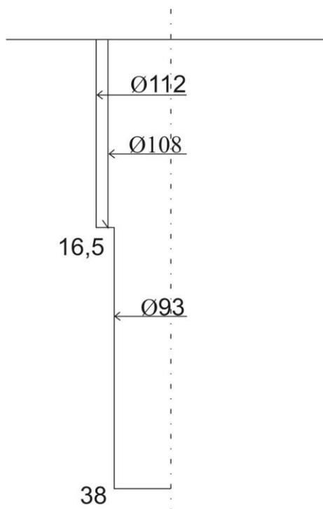
Рисунок 2.1 – Конструкция скважины
