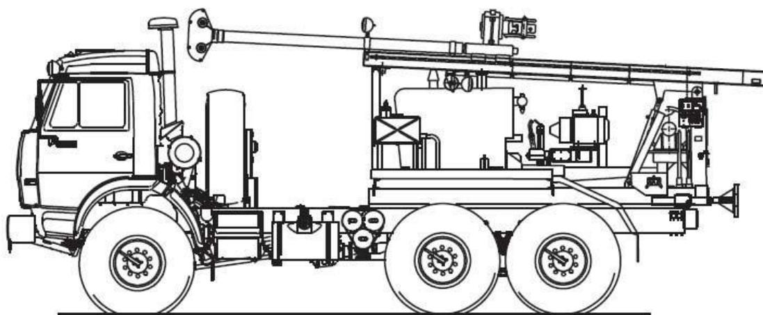
Рисунок 2.2 – Буровая установка ПБУ-2
