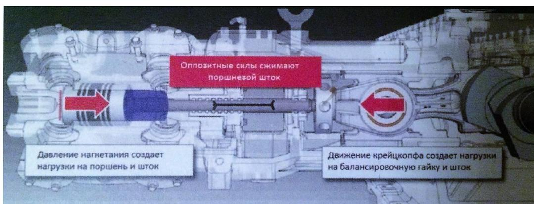
Рисунок 47 – Оппозитные силы сжимают шток
