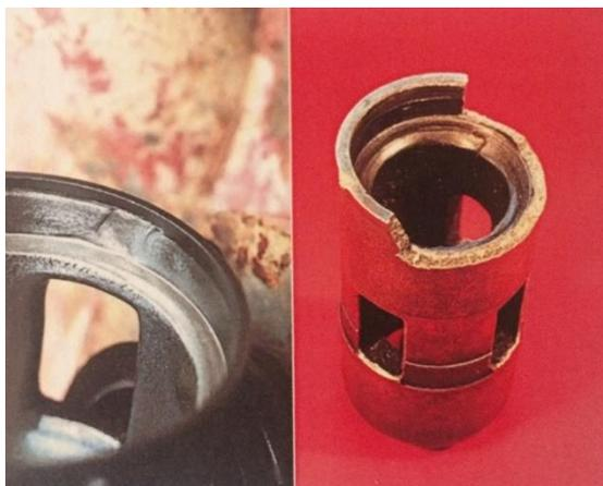
Рисунок 44 – Поломка клапанного седла
