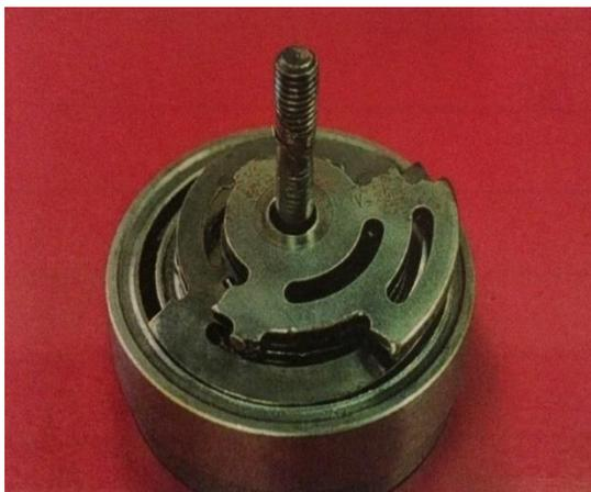
Рисунок 42 – Разрушение, вызванное неправильной установкой
