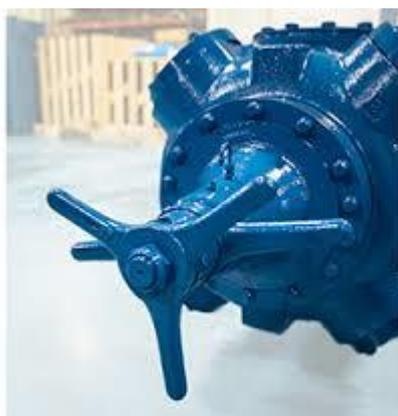
Рисунок 15 – Штурвал для регулировки производительности
