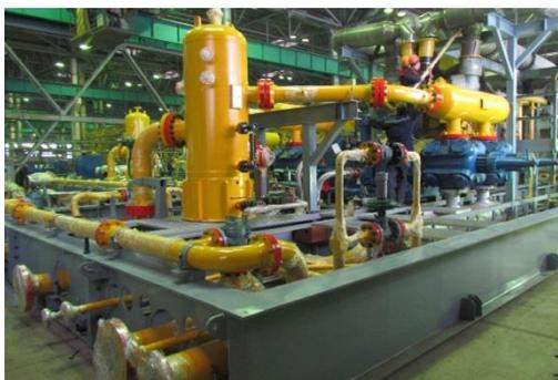
Рисунок 19 – Установка частей компрессора на раму
