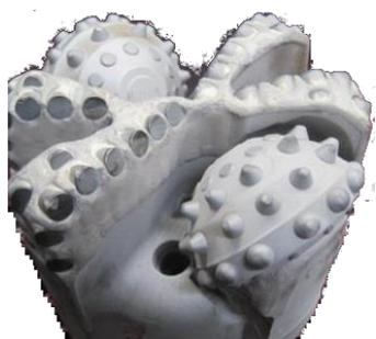
При Третьим спуском гибридного долота Кумера пробурено 963 фута (293,5 м) за 49,5 часа включая СПО). Долото было поднято изза выхода из строя двигателя и результат был успешным резцы PDC где были сколы начали рушаться некоторые были снесены конические шарошки только начали изнашиваться.
