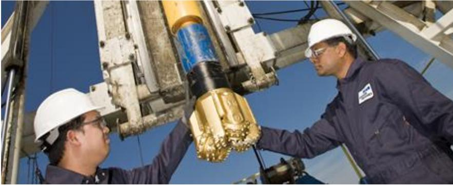
Комбинированное применение алмазного бурения и дробления породы при помощи конических шарошек позволяет данному долоту справляться даже с трудной цементированной обломочной горной породой (конгломератом). Шарошки улучшают динамические характеристики долота, за счет уменьшения его крутильных колебаний, а алмазные резцы позволяют получить ровные стенки скважины, что в свою очередь, позволит избежать подсакивания долота на забое.
