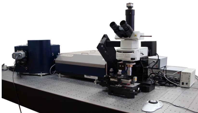
Рисунок 16 – Рамановский спектрометр Centaur UHR
