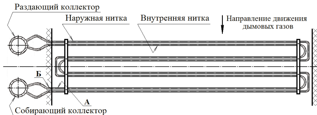
Рис. 1. Вид сверху на горизонтальный пароперегреватель технологического котла
