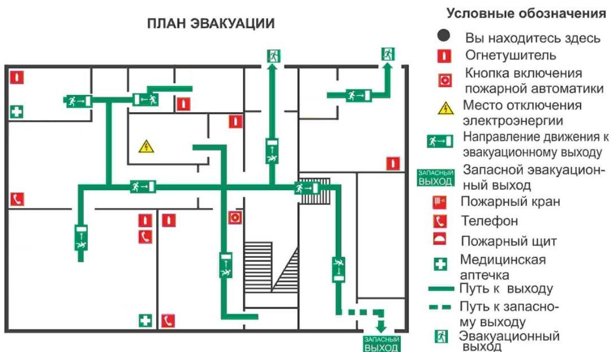
Рисунок 6.2. План эвакуации этажа при пожаре и других чрезвычайных ситуациях
