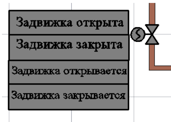
Рисунок 16 – Контроль состояний задвижки
