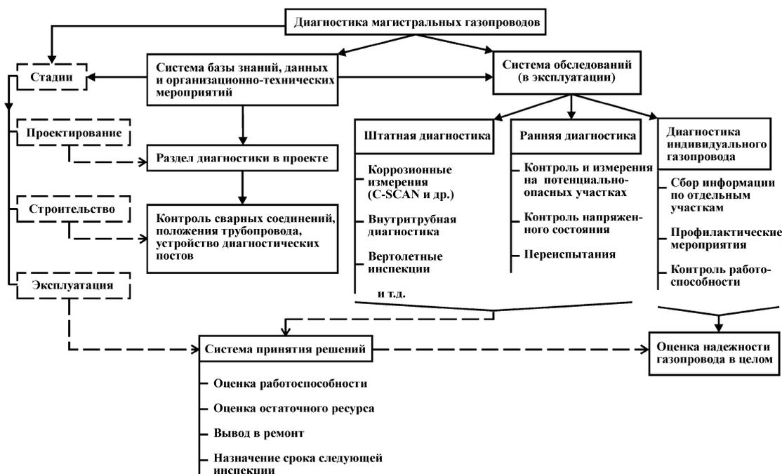
**Рис. 3. Принципиальная схема комплексной диагностики и принятия решения об эксплуатации газопроводов**
