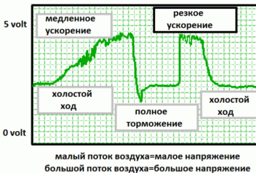
Рисунок 5 – выходной сигнал ДМРВ BOSCH 022624845
