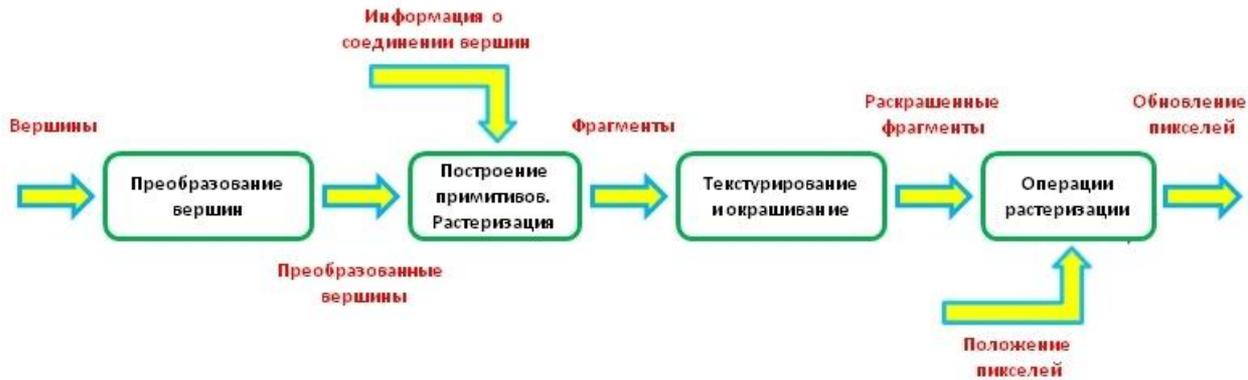
Рисунок 2 – Графический конвейер
