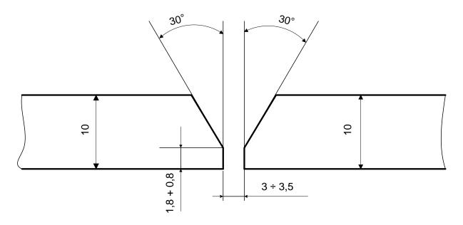
Рисунок 6.3 Разделка кромок труб для ручной дуговой сварки
