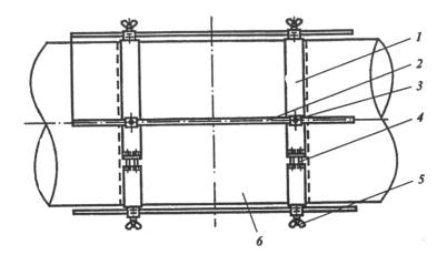
Рисунок 6.4 Шаблон для разметки катушек: 1-хомут; 2-напрвляющий стержень; 3-втулка; 4-затяжной болт; 5-винт-фиксатор; 6-трубопровод
