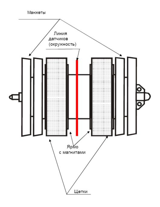
Рис.2.1 Схема построения магнитной системы дефектоскопа с продольным намагничиванием.
