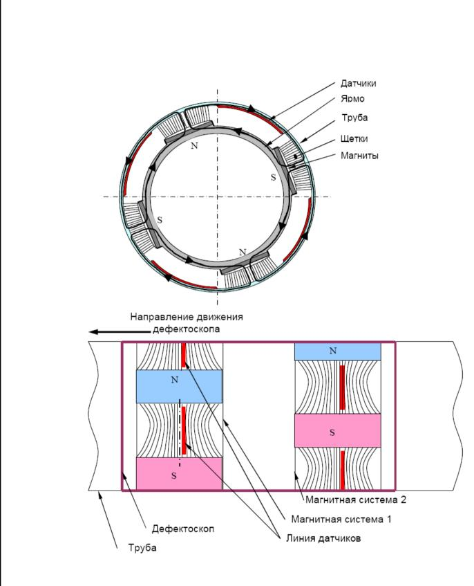
Рис. 2.2 Схема построения магнитной системы дефектоскопа с поперечным намагничиванием.
