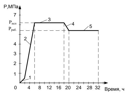
Рисунок 7.1 График изменения давления при гидравлическом испытании трубы: 1- заполнение трубы водой; 2-подъём давления до Р<sub>исп.</sub>; 3-испытание на прочность; 4- снижение давления; 5- проверка на герметичность.
