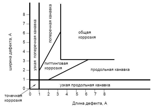
Рис. 2.7 Геометрические параметры дефектов.
