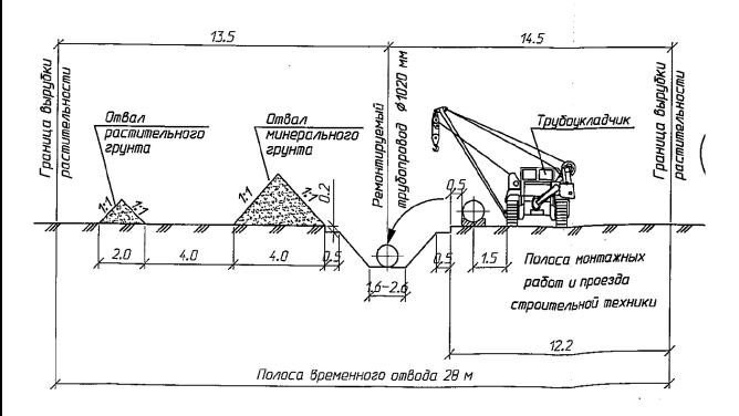
Рис. 6.2 Параметры ремонтного котлована
