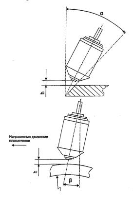
Рисунок 5.1 — Схема установки плазмотрона на трубе при полуавтоматической резке.
