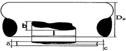
Рис. 2.11 Стенка трубы, подверженной коррозии
