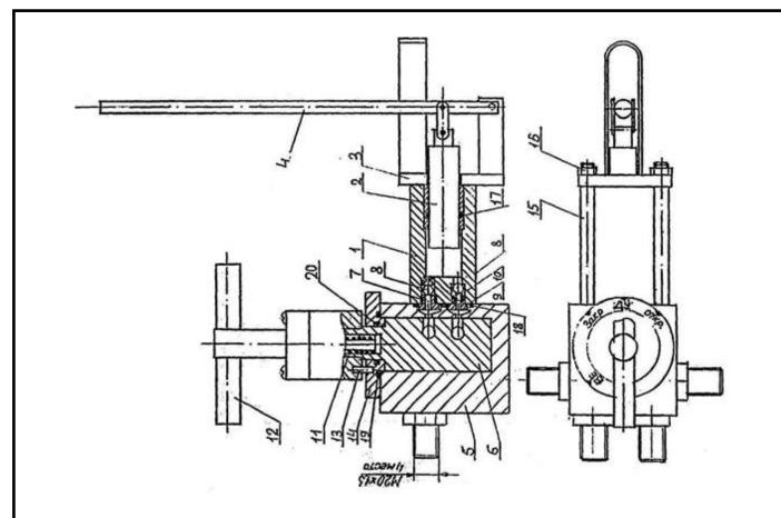
Рисунок 7.3 Устройство насоса НГ-25.000.00
