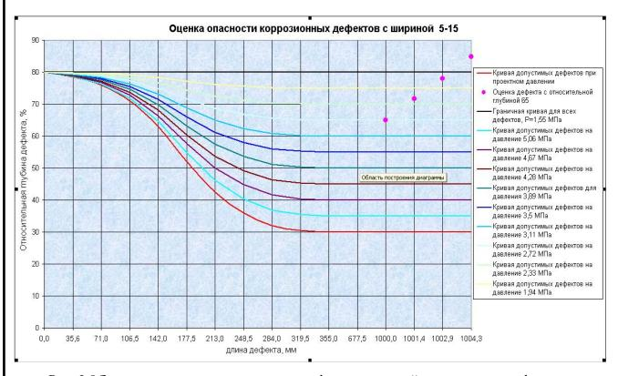
Рис. 2.8 Зависимость степени опасности дефектов от линейных размеров дефектов
