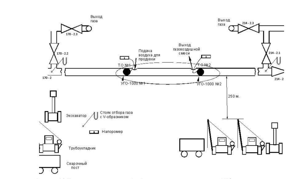
Рисунок 4.2 Производство огневых работ. Расстановка техники, установка УГО для продувки.
