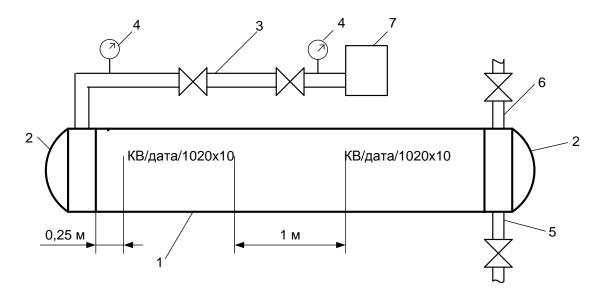
Рисунок 7.2: 1-труба 1020×10 (марка стали 17ГСУ); 2-сферические заглушки; 3-шлейф; 4-манометры; 5-сливной патрубок; 6-воздухоспускной патрубок; 7-гидравлический насос.
