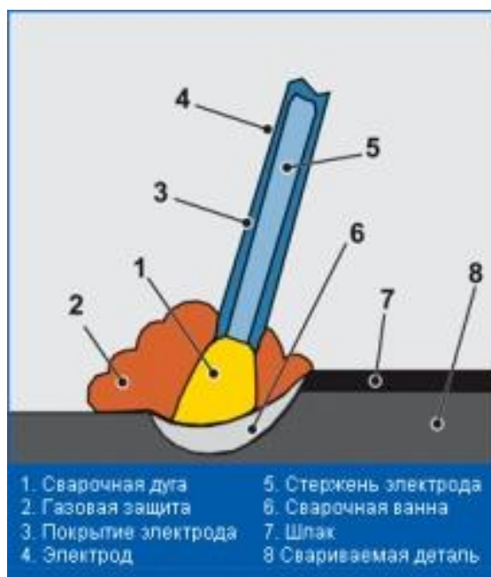
Рисунок 1 – Ручная дуговая сварка покрытым электродом.
