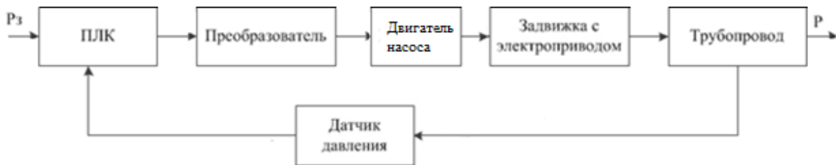
Рисунок 11 – Функциональная схема системы поддержания давления в трубопроводе
