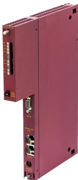
Рисунок 7 – Центральный процессор СК-4000
