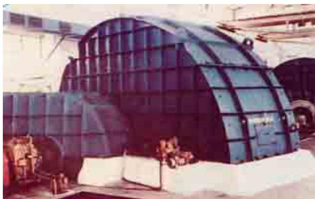
Рисунок 1 – Вентилятор главного проветривания ВОД30М2
