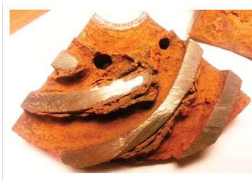
Рисунок 4 — Лопатки закрытого рабочего колеса центробежного насоса в разрезе
