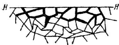
Рисунок 1.2 – Межкристаллитная коррозия.
