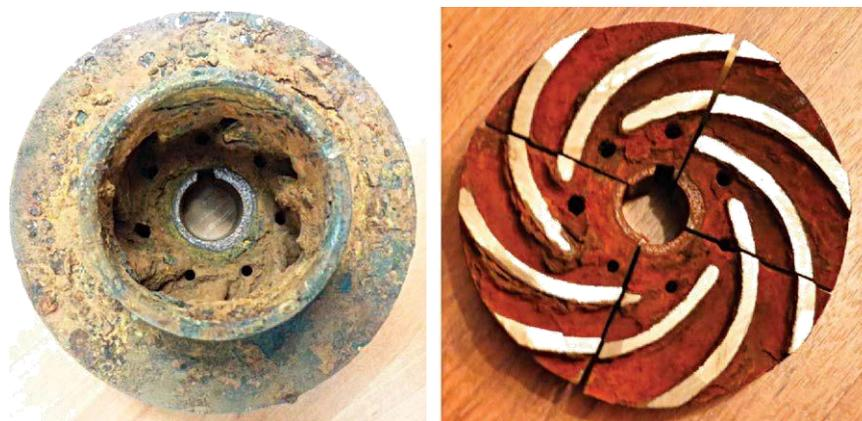
Рисунок 2 — Коррозионное повреждение закрытого рабочего колеса :
