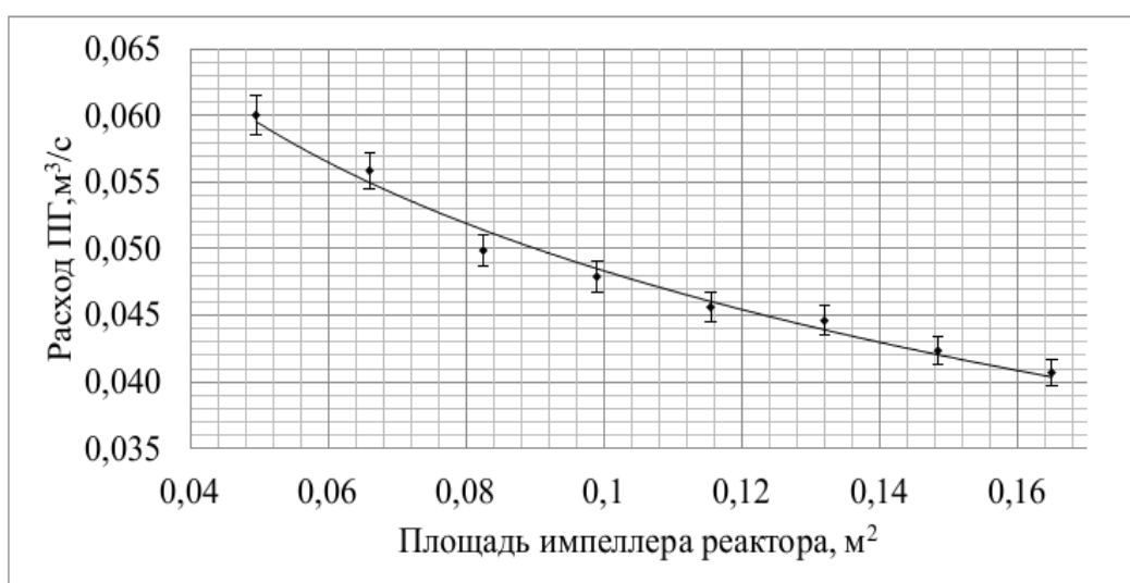
Рисунок 3.4 Влияние входной площади импеллера реактора на объёмный расход воздуха через ВЧФ-плазмотрон
