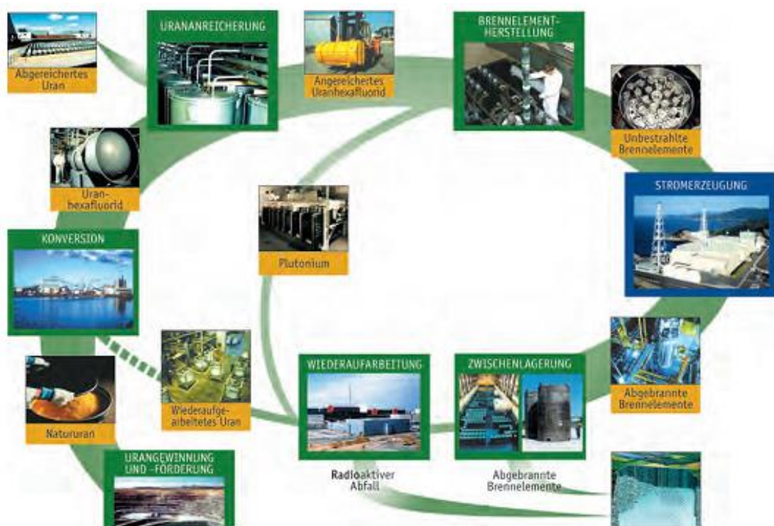
Abbildung A.1 Der nukleare Brennstoffkreislauf
