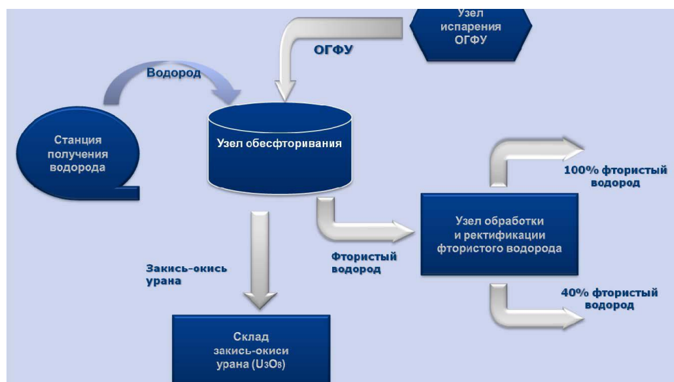
Рисунок 1.8 Схема установки «W-ЭХЗ»
