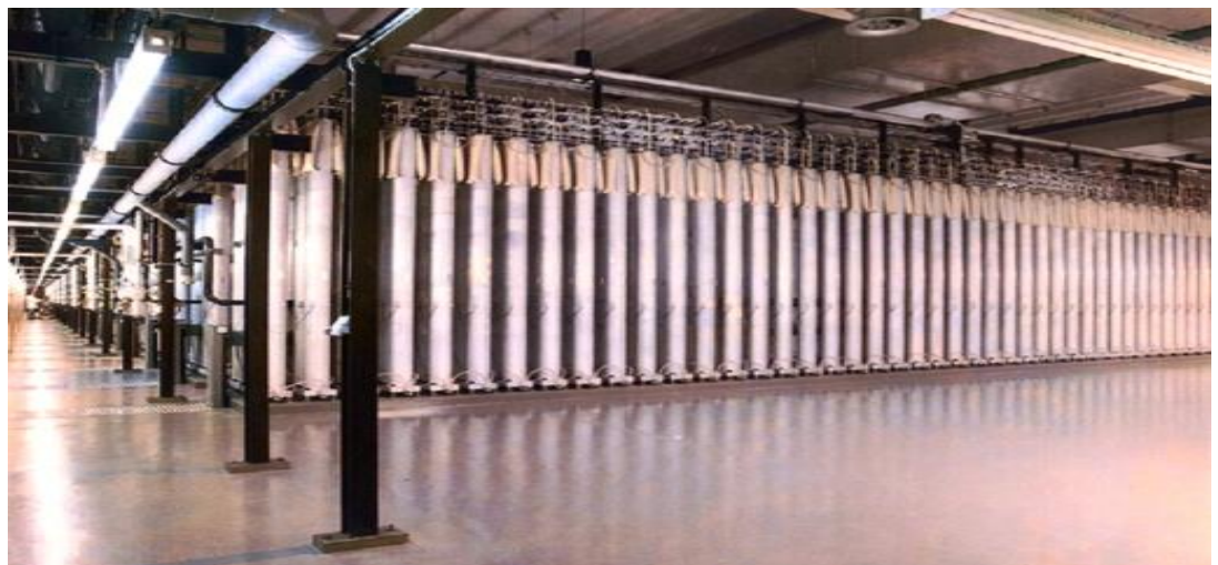
Abbildung A.3 Urananreicherung mit Zentrifugen (Urenco)
