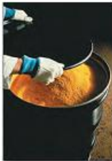
Abbildung A.2 Das auch «yellow cake» genannte Urankonzentrat ( \text{U}_3\text{O}_8 )
