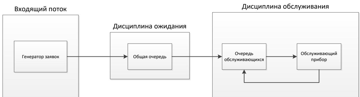
Рисунок 3.6 – Схема функционирования СМО с циклической дисциплиной обслуживания
