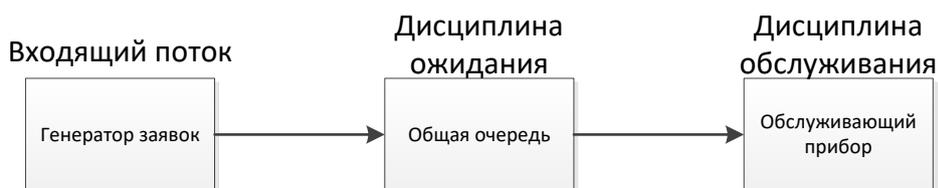
Рисунок 3.7 - Схема функционирования «линейной» СМО
