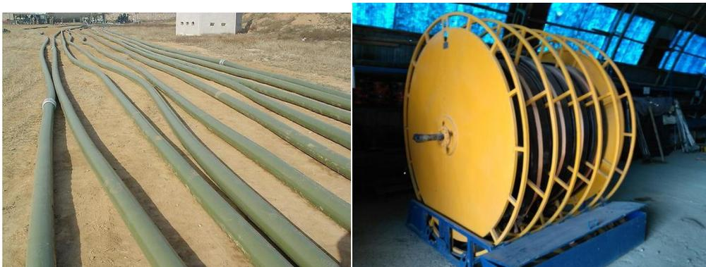
Рисунок 18 - Плоскосворачиваемые рукава
