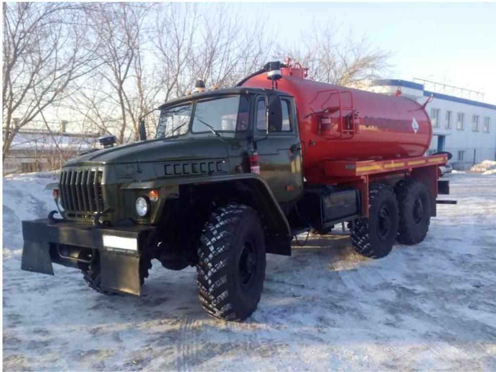
Рисунок 21 – Агрегат для сбора газового конденсата и нефтепродуктов АКН-10 (шасси УРАЛ-4320-60(70))
