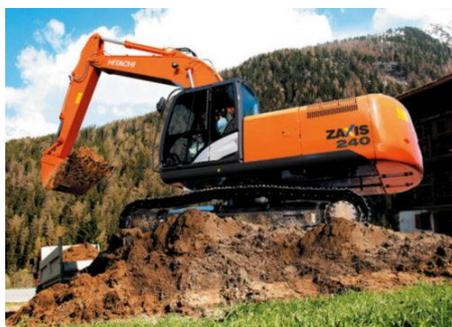
Рисунок 7 – Экскаватор Hitachi ZX240-5G
