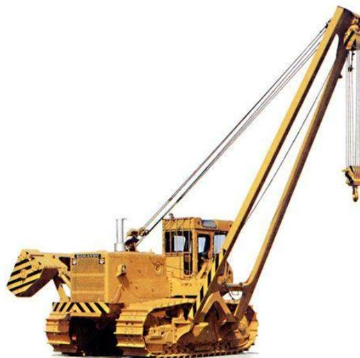
Рисунок 24 – Трубоукладчик KOMATSU D355C
