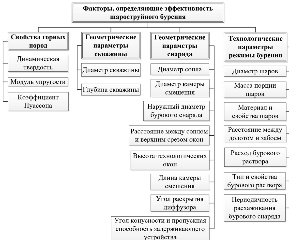
Рисунок 3 – Классификация факторов, определяющих эффективность шароструйного бурения
