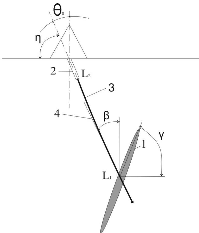
Рисунок 2.4 – Профиль скважины: 1 – пласт полезного ископаемого; 2 – обсадная колонна; 3 – ствол скважины ниже последней обсадной колонны; 4 – касательная к оси скважины в точке встречи с кровлей пласта
