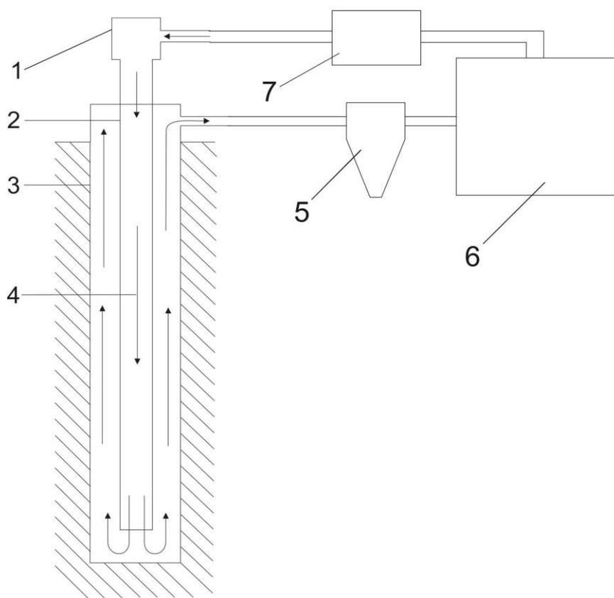
Рисунок 2.1 – Схема циркуляции промывочной жидкости: 1 – сальник-вертлюг; 2 – буровые трубы; 3 – стенки скважины; 4 – направление потока промывочной жидкости; 5 – гидроциклонная установка; 6 – зумпф; 7 – насос
