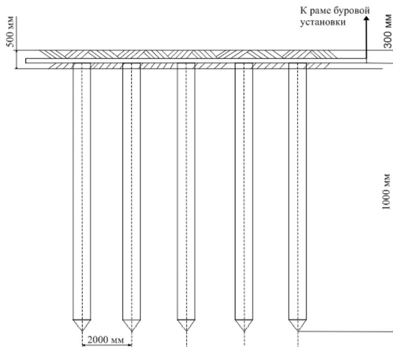
Рисунок 3.1 – Схема заземления
