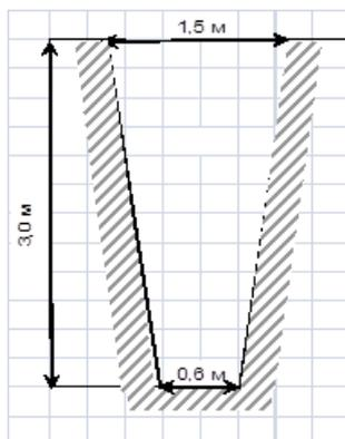
Рисунок 1.1 – Поперечное сечение канавы
