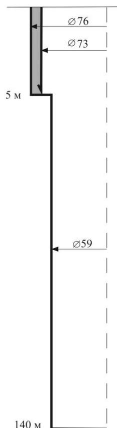
Рисунок 2.2 – Конструкция скважины
