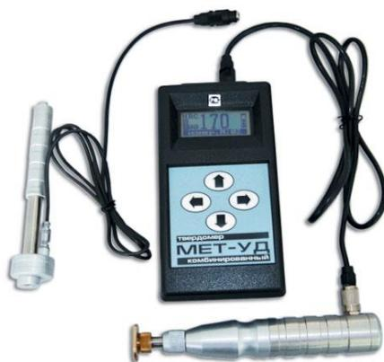
Рисунок 13 MET-УД - портативный комбинированный твердомер [19]
