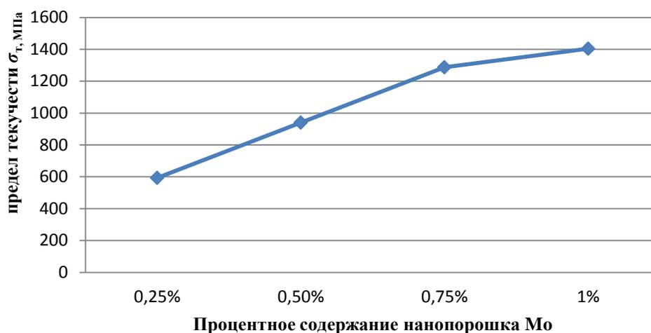
Рисунок 17 График зависимости предела текучести от процентного содержания нанопорошка молибдена
