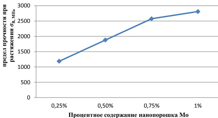
Рисунок 15 График зависимости предела прочности от процентного содержания нанопорошка молибдена
