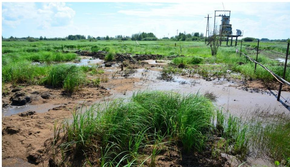
Рисунок 3.7 Разлив нефти с сорбентом «торф гранулированный» (фото автора)
