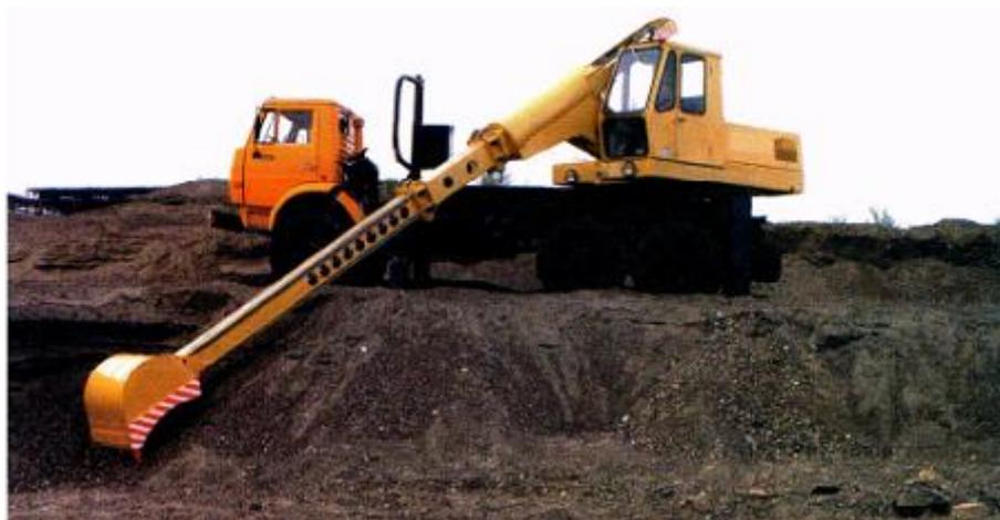
Рис. 21 – Универсальный экскаватор на шасси автомобиля КАМАЗ
