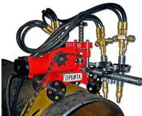
Рис. 37 – Газорезательная машина «Орбита-БМ»
