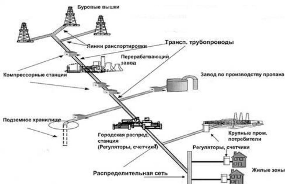
Рис. 1 – Схема системы транспортировки природного газа
