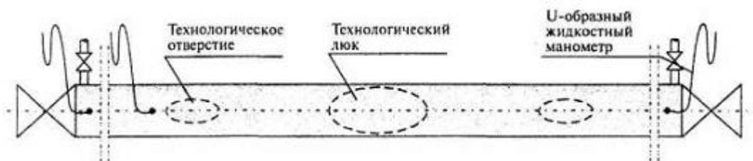
Рис. 33 – Вырезка технологических отверстий и технологического люка
