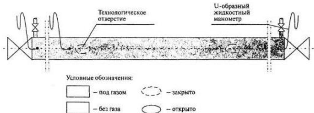
Рис. 24 – Вырезка технологических отверстий
