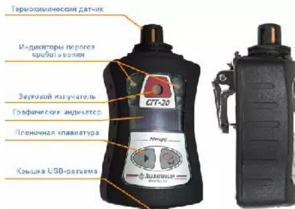
Рис. 22 – Газоанализатор СГГ – 20 Микро
