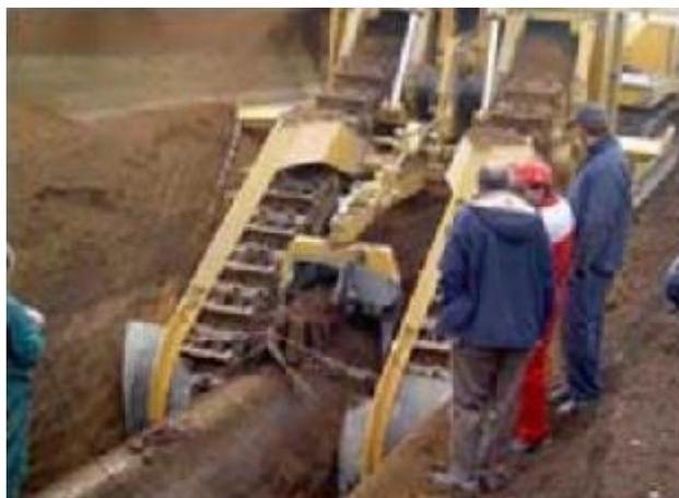
Рис. 20 – Машина вскрытия трубопроводов МВТ
