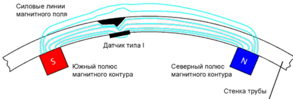
Рис.15 – Принцип поперечного намагничивания трубопровода и регистрации сигналов датчиками типа I (TFI)
