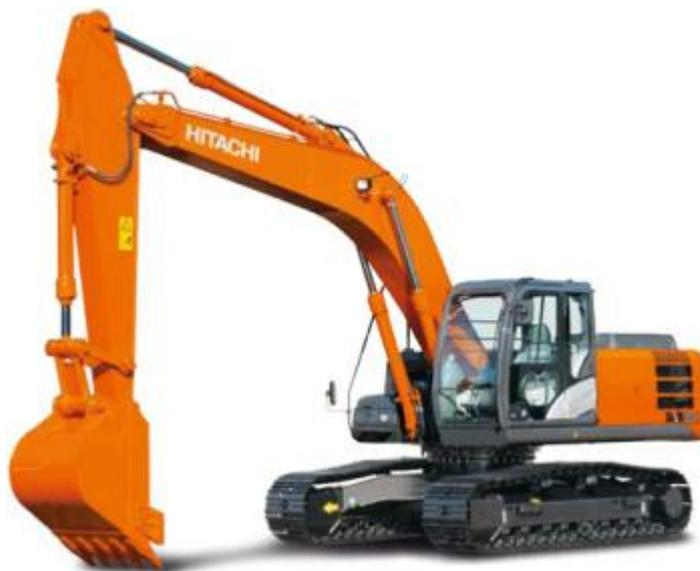
Рис. 17 – Экскаватор одноковшовый с обратной лопатой HITACHI ZX 240
