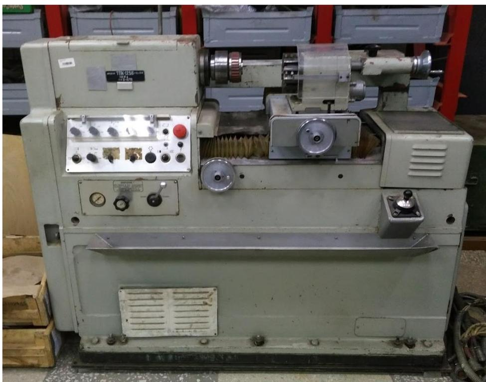
Рис. 3. Модернизируемый токарный станок ТПК-125
