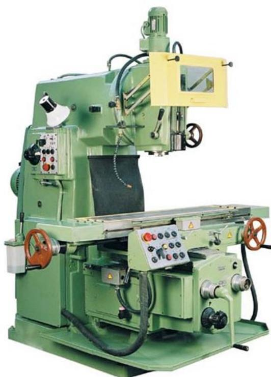
Рис.25. Вертикальный консольно-фрезерный станок 6Т12
