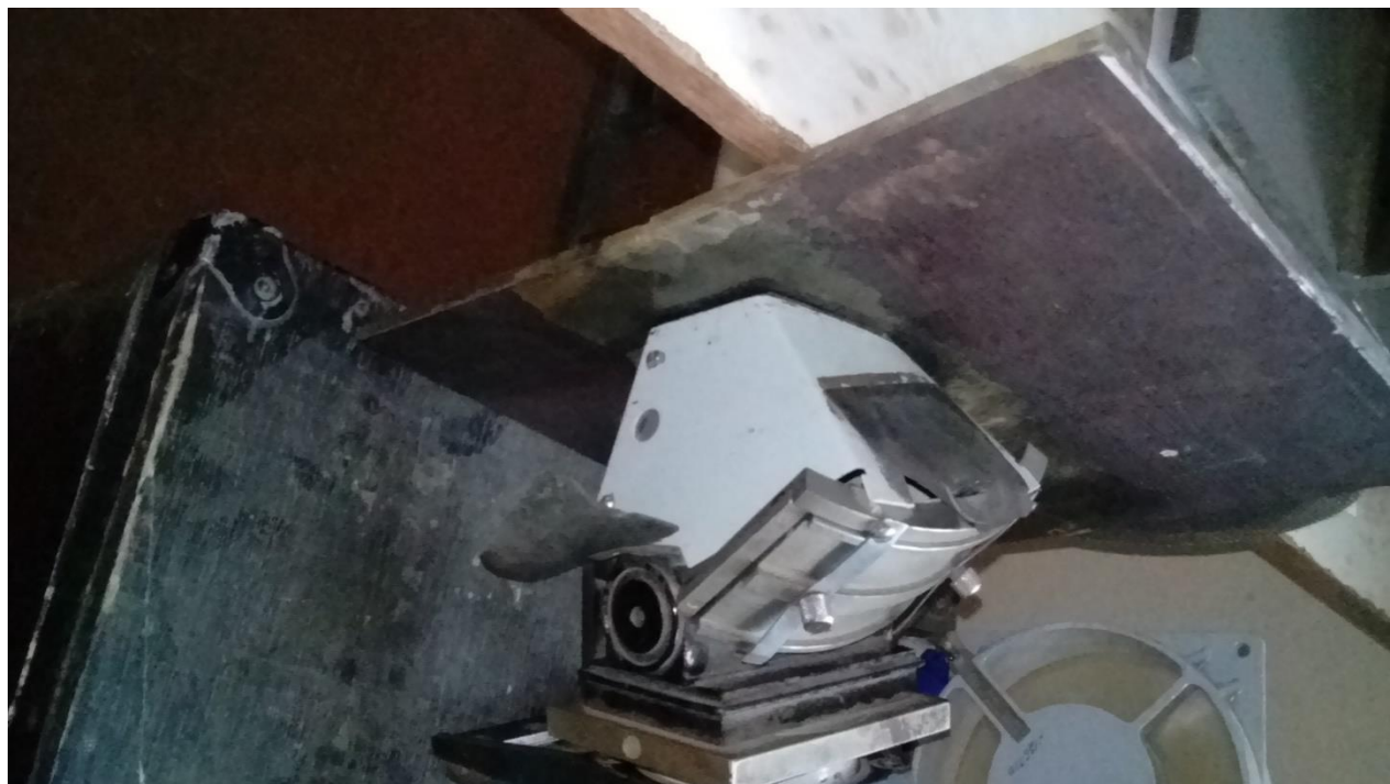
Рис 4.9 – Совмещение рисок на измерительном блоке с разметками на пластине
