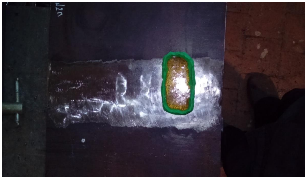
Рис.4.6 – Химическое травления поверхности с помощью «царской водки»
