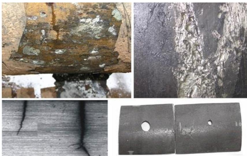
Рис. 1.1 – Коррозия трубопроводов
