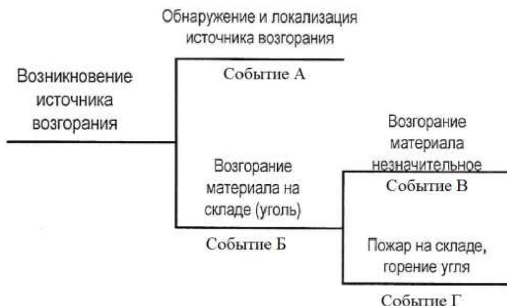
Рисунок 4.2 – Дерево событий при возникновении источника возгорания на угольном складе
