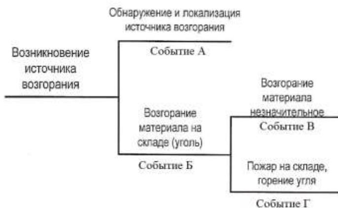
Рисунок 1 – Дерево событий при возникновении источника возгорания
